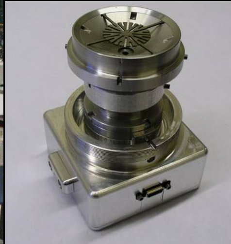
Detector package EM 500 grams 0.6 Watt
